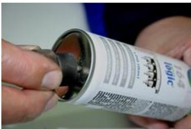
4. Dose mit montiertem Luftanschlussadapter auf den am Fahrzeug bereits angeschraubten Fülladapter montieren. Handfest anziehen.
