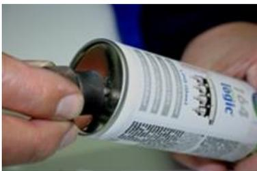
2. Luftanschlussadapter (Art.-Nr. 11 1342) in die Öffnung am Dosenboden einschrauben bis die Öffnung abgedichtet ist.
