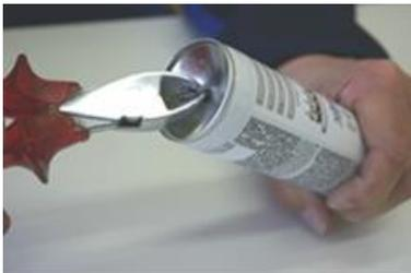
1. Gummistopfen mit geeignetem Werkzeug aus dem Dosenboden entfernen. Achtung! Dose dabei vom Körper weghalten.
