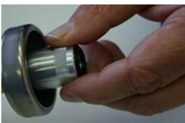
3. Tankklappe und/oder Schutzkappe für Gasfüllanschluss öffnen. LPG Adapter (Art.-Nr. 11 1340 oder 11 1341) fest auf den Füllanschluss aufschrauben. Wenn notwendig passenden Adapter auf [www.autogasadapter.de](http://www.autogasadapter.de) bestellen.
