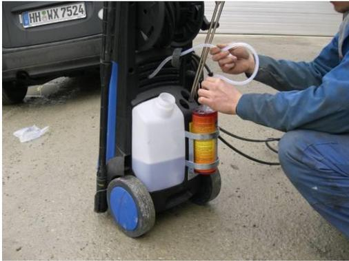
Reiniger in den vorgesehenen Korb am Hochdruckreiniger einsetzen. Zuleitung vom Tank zur Reinigerflasche umstecken.
