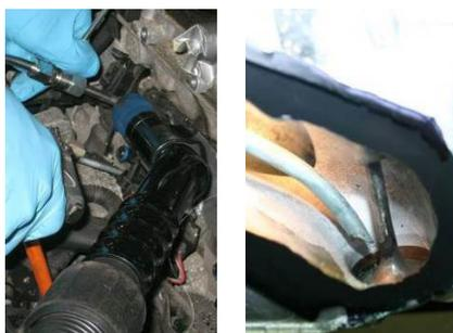
11. Insertar la boquilla rociadora adecuada (6,7) en la manguera para adaptador (3) en la dirección de la válvula/área de aspiración por limpiar.
