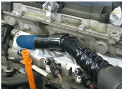
7. Poner el cilindro por limpiar en Punto Muerto Superior para asegurar que las válvulas estén cerradas. **Nota: ¡La limpieza solo puede realizarse con las válvulas cerradas!**
