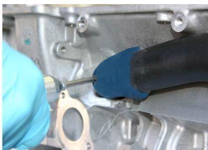
15. Het uitblaaspistool (8) op de persluchttoevoer aansluiten.
