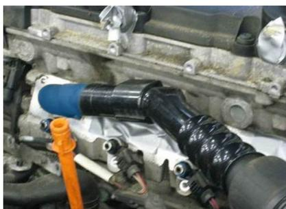
7. De te reinigen cilinders in het BDP (bovenste dode punt) zetten, zodat de kleppen gesloten zijn. **Opmerking: De reiniging alleen bij gesloten kleppen uitvoeren!**
